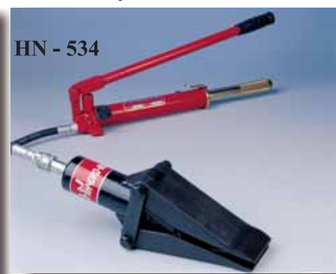
HN - 534 Peso del Expansor: 9,36 Kg. Peso Bomba Manual: 3,6 Kg. Largo: 330 mm. Apertura Operativa: 115 mm. Potencia Máxima: 7,500 Kg.
