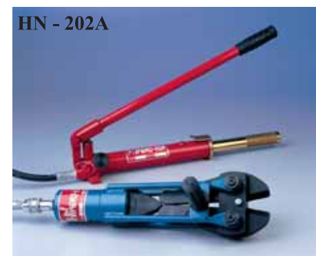
HN - 202A Peso Bomba Manual: 3,6 Kg. Peso Cizallas: 7,92 Kg Largo: 480 mm. Ancho: 125 mm. Corta: Acero Templado: 16 mm. Acero Común: 20 mm. Potencia Máxima: 35,000 Kg.
