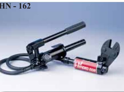
HN - 162 Peso: 4,7 Kg. Largo: 270 mm. Corta: Acero Templado: 6 mm. Acero Común: 10 mm. Potencia Máxima: 10,000 Kg.
