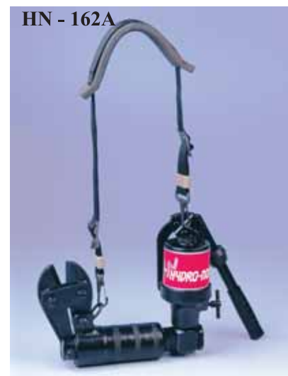
HN - 162A Peso: 4,4 Kg. Largo: 270 mm. Corta: Acero Templado: 6 mm. Acero Común: 10 mm. Potencia Máxima: 10,000 Kg.
