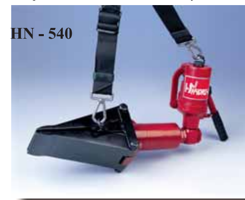
HN - 540 Peso: 11,6 Kg. Largo: 430 mm. Ancho: 125 mm. Apertura Operativa: 115 mm. Potencia Máxima: 5,000 Kg.
