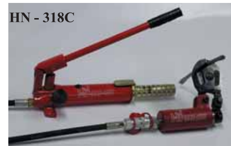
HN - 318C Peso: 2,5 Kg. Largo: 222 mm. Altura: 167mm Ancho: 50 mm Corta: Cables de acero: 10 mm. (para rescate) Acero Común: 10 mm. Potencia Máxima: 10,000de Kg.
