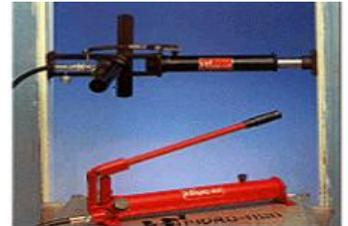
Hand Pump 무게 5.7kg / 도아 파괴력 22,800kg / 폭 (접었을 때)732mm, (펼쳤을 때)980mm
